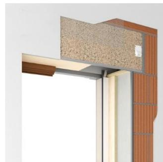
LA SPALLA FILO MURO è realizzata con materiali capaci di un'ottima prestazione isolante e studiata per esaltare le prestazioni termiche e facilitare la posa. È formata da uno strato in EPS, per uno spessore totale di 100 mm. È completa
